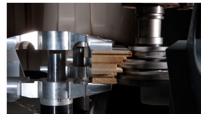
Husillos de fresado refrigerados por líquido con regulación vectorial
