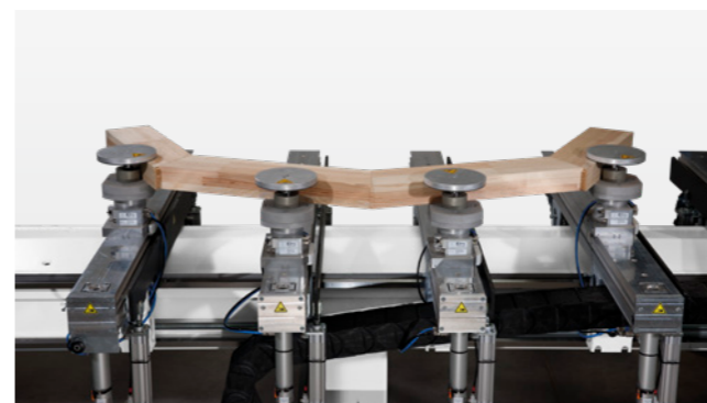
Mecanizado de elementos de arco, puertas y piezas planas
