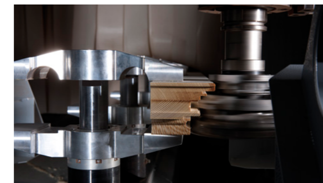
Flüssigkeitsgekühlte Frässpindeln mit Vektorregelung
