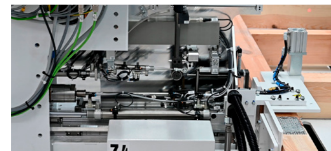
Schraubaggregat zum Verschrauben von Riegelwerken.
