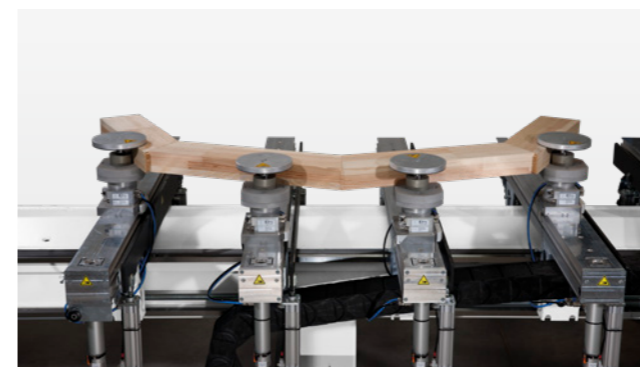
Bearbeitung von Bogenelementen, Türen und Flächenteilen
