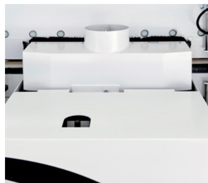
Grupo fresador-ensamblador: Corte perfecto y larga vida útil gracias a las herramientas con punta de diamante para asegurar una calidad óptima de ensamblado de los cantos.
