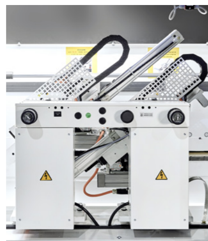
Grupo de retestado: Aplicando unos cortes exactos, el lado delantero se puede cortar recto o en bisel.
