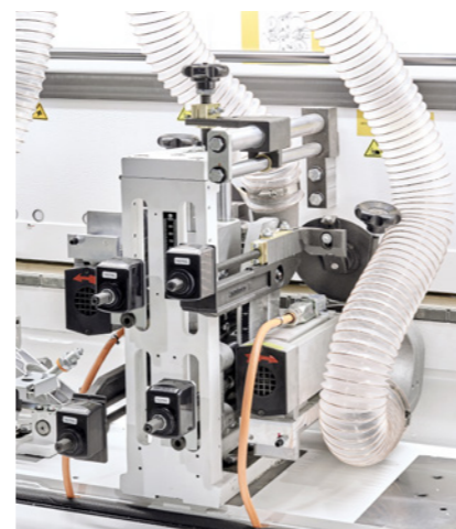
Grupo fresador de bisel/radio: Este grupo fresador con ajuste de 2 puntos es ideal para cambiar con rapidez entre cantos finos y gruesos.
