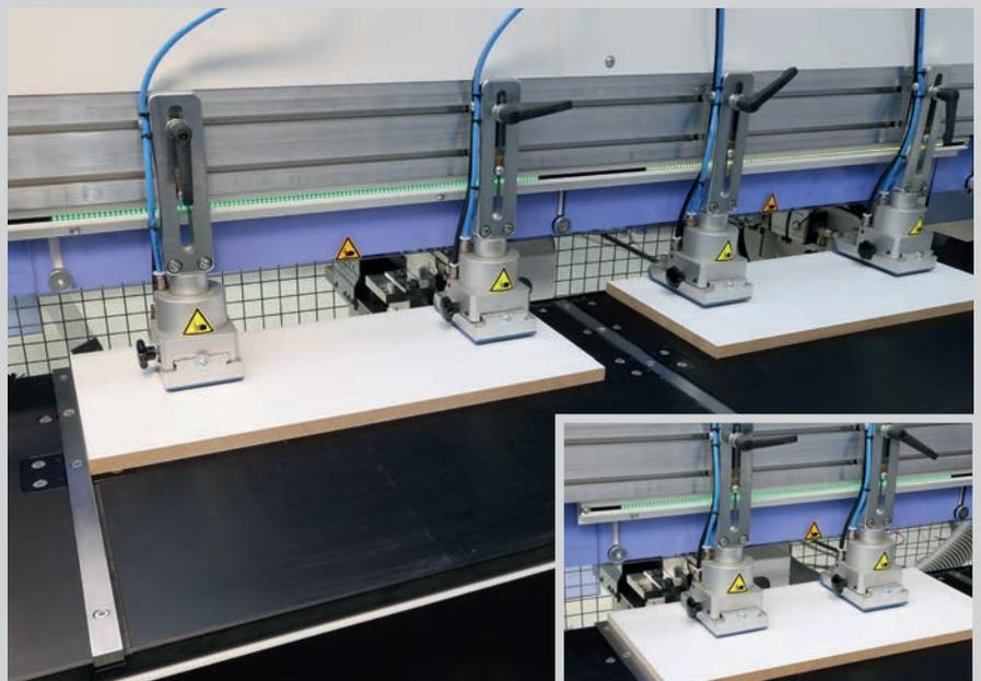
**OPTISCHES LED-ASSISTENZSYSTEM** zur Unterstützung des Maschinenbedieners bei der Bearbeitung von Werkstücken. Die LED-Leiste leuchtet in den Bereichen, wo die Werkstücke positioniert werden sollen. Dabei entspricht die Länge der leuchtenden Bereiche der Länge der zu positionierenden Werkstücke. Sobald die Positionierung korrekt ist, wechselt die Farbe der LED-Leiste.
