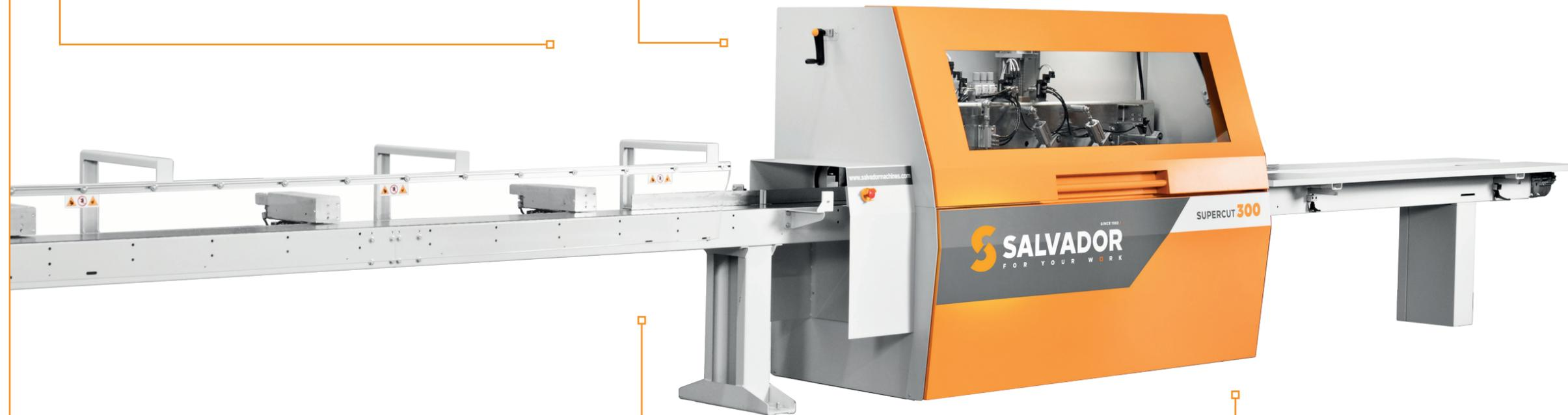
+ Top drive unit with three motorised toothed wheels and 6 idle rollers. Gruppo di traino superiore con tre ruote dentate motorizzate e 6 rulli folli.
