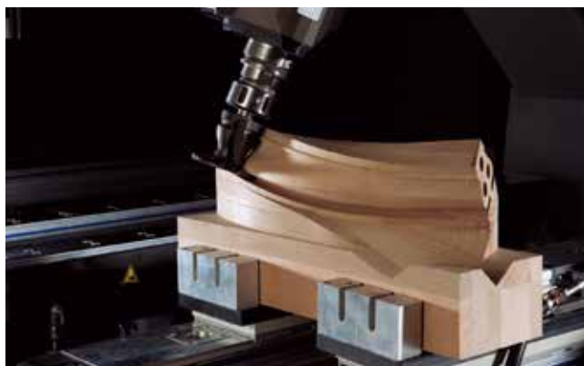
frezowanie poręczy schodów
