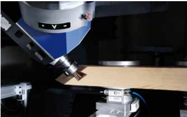
frezowanie połączeń na jaskółczy ogon na belkach pionowych i konstrukcjach ramiakowych
