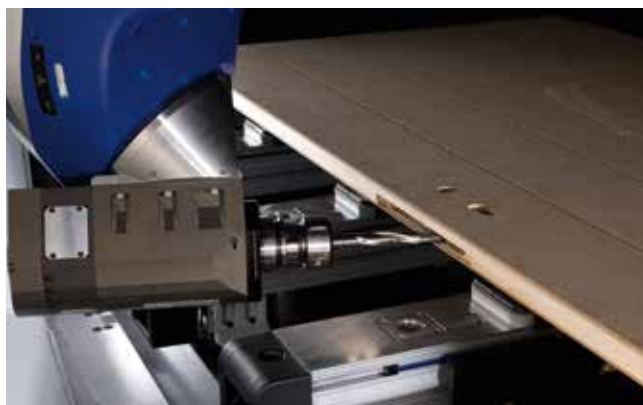
frezowanie kieszeni pod zamki
