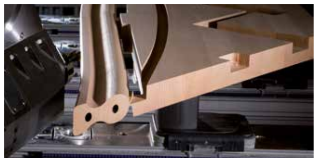
wiercenie otworów pod tralki pod małym kątem
