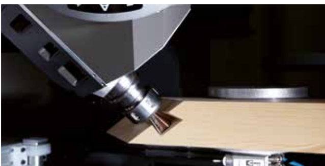
frezowanie połączeń na jaskółczy ogon na belkach pionowych i konstrukcjach ramiakowych
