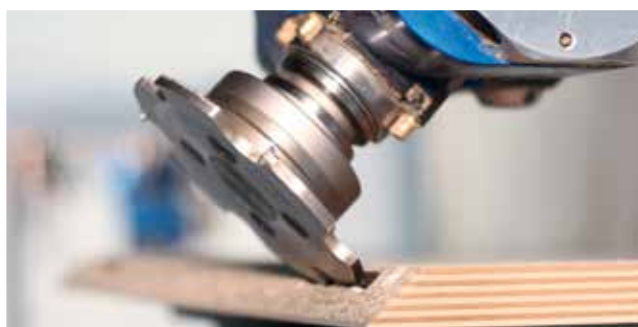
frezowanie otworów pod okucia połączeniowe
