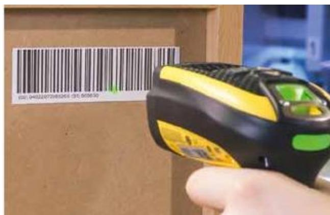
バーコードコントロールシステムは、データの入力を簡単に行うことができます。バーコードをスキャンするだけで、生産リストを参照し、必要なデータがすべて入ったカッティングマシンに転送されます。
