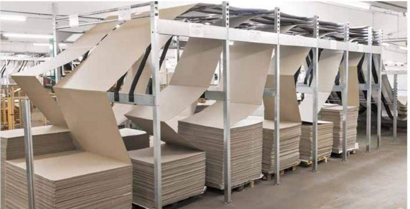
サイド・バイ・サイド・モードでは、連続ダンボールの供給スロットにさらにトラックが追加され、6連マガジンシステムでは最大12のシート幅の供給が可能になります。
