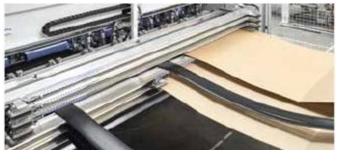
連続シートマガジンは、最大6連のシート幅に対応した自動交換システムです。
