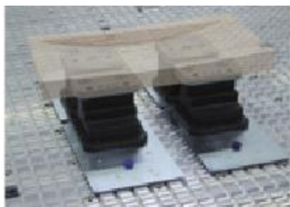
Maxi-Flex システム 自由に吸着パッド位置をずらす事が可能な ベースプレートを利用した吸着パッド
