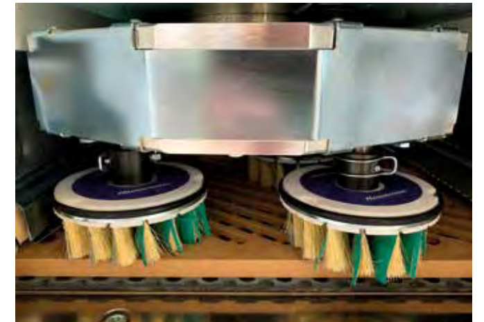
Praktisch und schnell zugänglich: das auf Schienen gelagerte DB-S-Tellerbürstenaggregat
