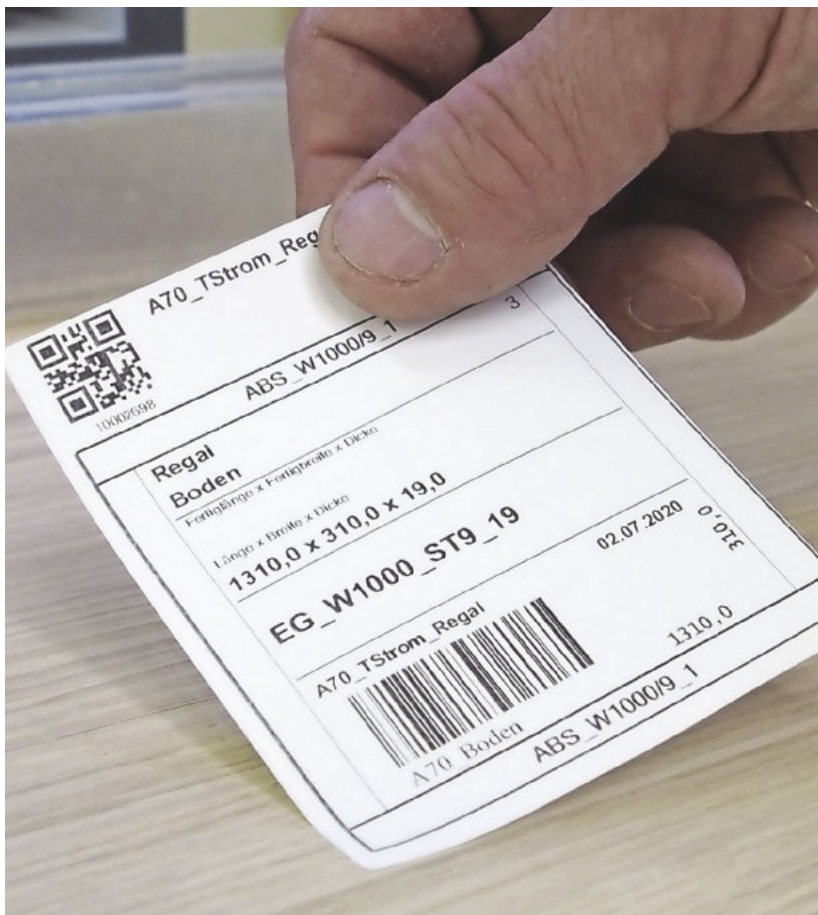
/ Ist ein Möbelteil zugeschnitten, wirft der Drucker das Etikett aus. Dieses enthält das exakte Kantenbild und sämtliche weitere Teile- und, dank Barcode, auch Bearbeitungsinformationen.
