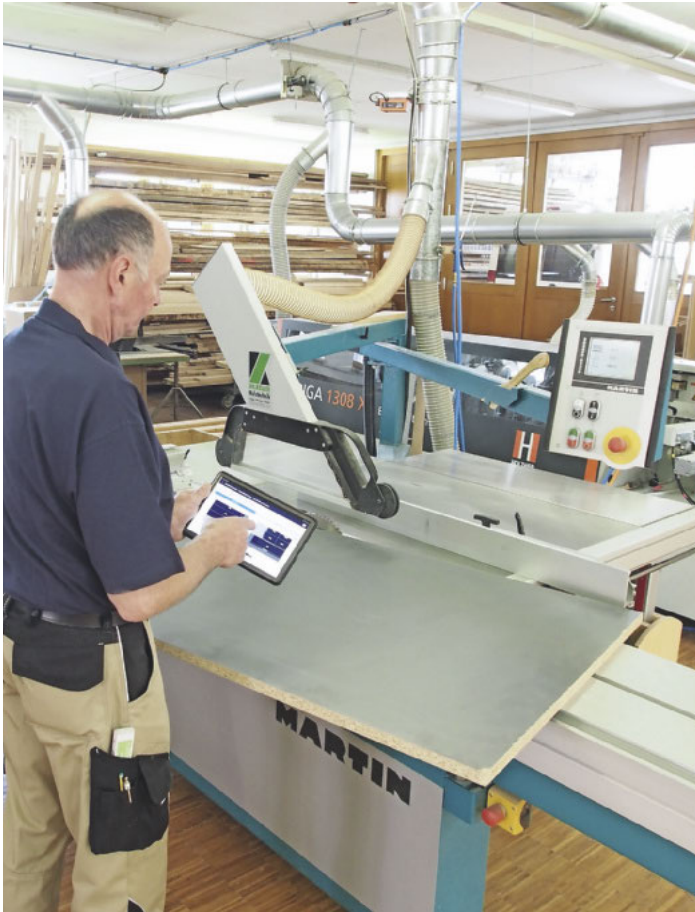
/ Manueller Zuschnitt leicht gemacht: Der ProductionAssist Cutting sorgt für einen effizienten Plattenzuschnitt auf jeder beliebigen Säge.
