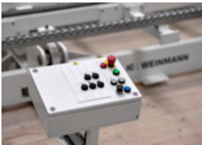
Lokales Bedienpult mit komplettem Steuersystem.
